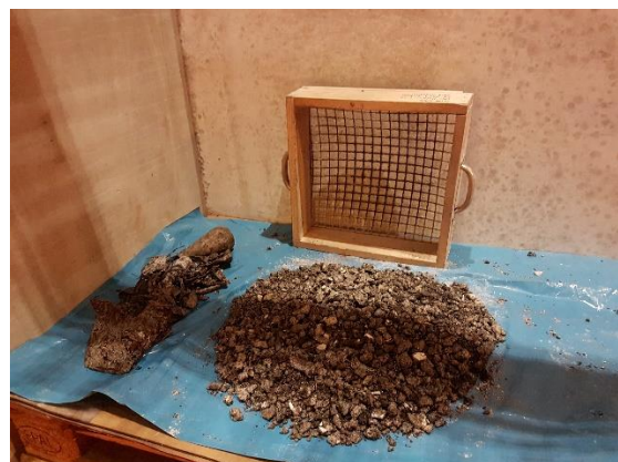
Knust og siktet delprøve av grov aske. Utsortert metall til venstre.
