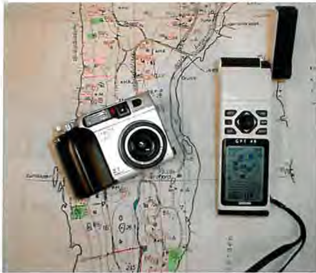
Figur 2.2 Feltutstyret; manuskartet, digitalt kamera og håndholdt GPS.
