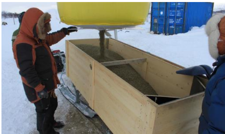
Bilde 11. Spesiallaget fôrslende for 800 kilos storsekker med graspellets.
