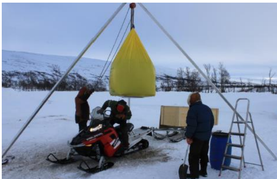
Bilde 10. Den spesialbygde fôringsleden kjøres under den 800 kg tunge storsekken med graspellets.
