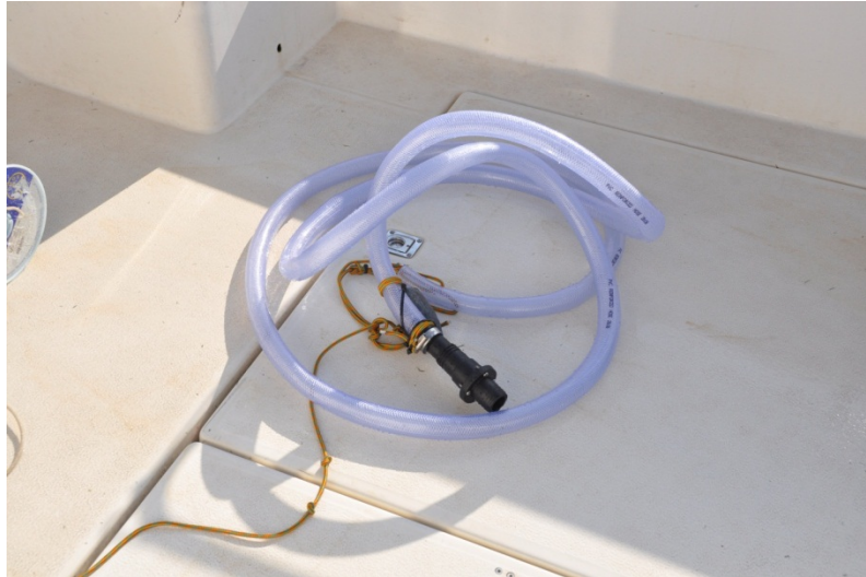
Figur 2: Prøvetakeren som ble benyttet for innsamling av vann til klorofyll a målinger. Denne består av en 5 m slange som samler ca. 5 L vann fra overflaten til 5 m dyp. Dette vannet helles over i en beholder hvor det blandes før deler av blandingen overføres til analyseflaske (1 L).
