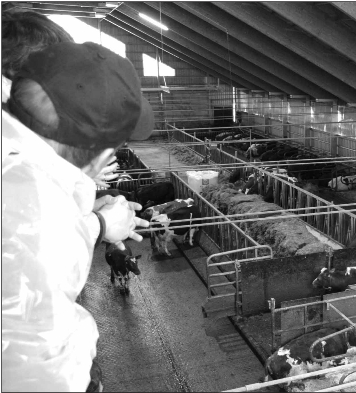
STØRST I PROSJEKTET: Inne i gigantfjøsene til brødrene Mikalsen. Bygd uisolert for frittgående melkekyr. Kald, sunn og rimelig. Og kyrne preges ikke negativt av selv streng kulde, beroliges det.
