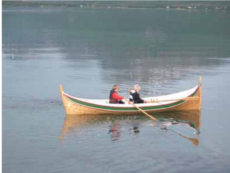
Fig. 4.4.1. Norges første Nordlandsbåt bygget i sitka. Sitka er et treslag som binder mye CO 2 , er sterkt og relativt lett.
